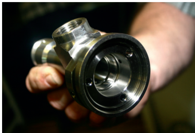
6 Moderne CNC-gesteuerte Werkzeugmaschinen ermöglichen es, auch komplexe Werkstücke in einer Aufspannung zu fertigen. Dadurch steigen Genauigkeit, Oberflächengüte und Produktivität
