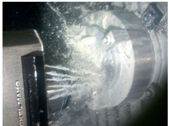
5 Im Fokus der Fertigung: die schnelle, produktive, hochgenaue Zerspänung, bei der keine Nacharbeit erforderlich ist
