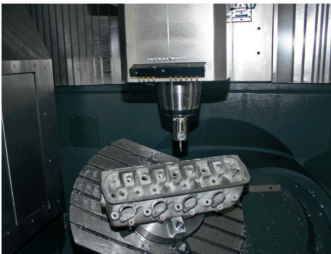
4 Mit fünf NC-Achsen ist die DMU 70 eVo linear auch für die fünfachsige simultane Konturbearbeitung geeignet. Bei komplexen Werkstücken wie diesem Motorblock dreht der NC-Schwenkrundtisch das Werkstück in seinem Schwerpunkt und ermöglicht bei Bedarf Hinterschnitte von bis zu 12°
