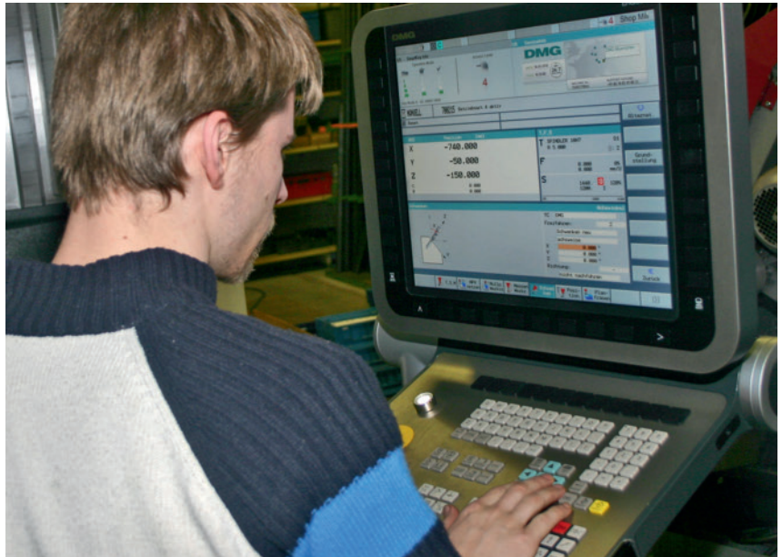
3 Die grafische Bedienoberfläche ShopMill der CNC Sinumerik 840D sl von Siemens erleichtert die Arbeit der Programmierer und der Einrichter
