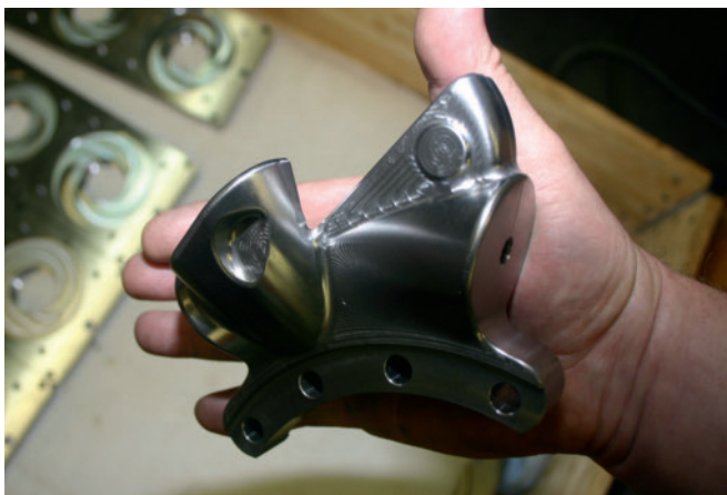
6 Moderne CNC-gesteuerte Werkzeugmaschinen ermöglichen es, auch komplexe Werkstücke in einer Aufspannung zu fertigen. Dadurch steigen Genauigkeit, Oberflächengüte und Produktivität
