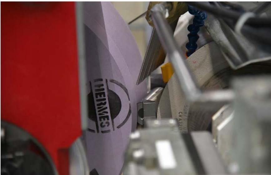
1 Spitzenlosschleifen auf einer Mikrosa Kronos S 250 im Rahmen von Schleifuntersuchungen am Werkzeugmaschinenlabor der RWTH Aachen (© RWTH Aachen)
