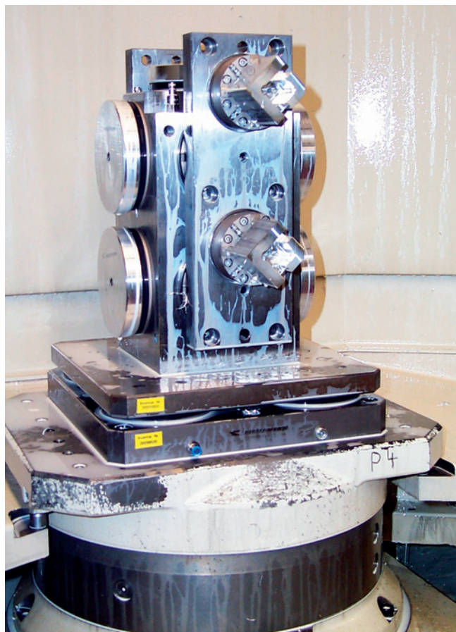
Das Spannsystem ›9000‹ ermöglicht einen sekundenschnellen Wechsel von Paletten, Vorrichtungen, Schraubstöcken und Werkstücken
