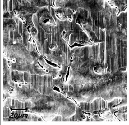
**■ Nach 602 Stunden Prüfstanddauerlauf: Zylinderlaufbahn im O.T.-Bereich (oben) und im mittleren Bereich (unten)**
