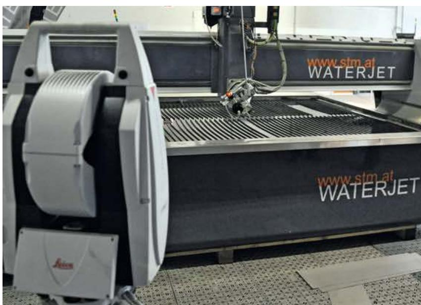
3 Entlang der Führungsschiene einer Wasserstrahl-Schneidemaschine werden verschiedene Punkte gemessen
