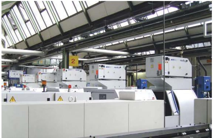
1 Die neuen, dezentralen Ölnebelabscheider sind auf den Drehmaschinen installiert
