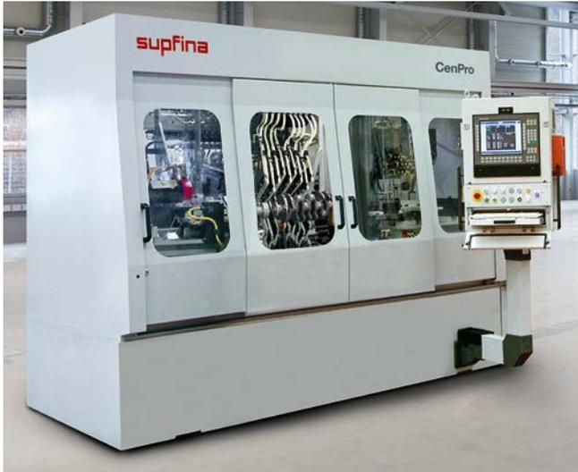
2 Supfina CenPro: modulares Produktionssystem für eine hohe Ausbringung in der Serien-Superfinishbearbeitung (Bild: Supfina)
