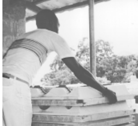
Les tuiles fraîchement fabriquées restent dans les moules pour sécher.
