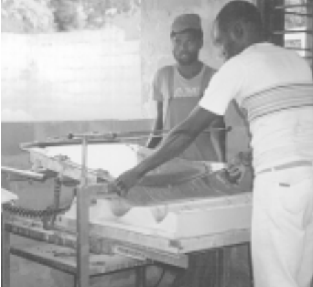
Transfert d'une tuile mouillée sur la place de séchage.
