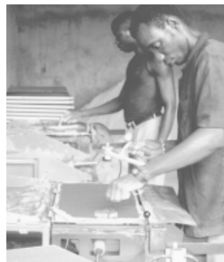
Moulage d'une tuile sur le vibreur.
