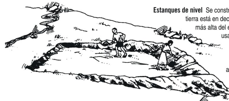
**Estanques de nivel** Se construyen en zonas donde la tierra está en declive. La tierra en la parte más alta del estanque se excava y se usa para construir un dique en la parte más baja. El dique tiene que ser sólido, pues el nivel del agua en el estanque será más alto que el nivel original del suelo.
