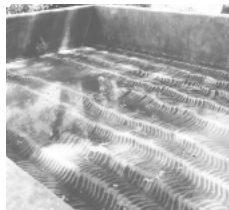
As telhas secas devem ser mergulhadas em água por pelo menos sete dias.
