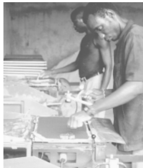
Modelando uma telha no vibrador.
