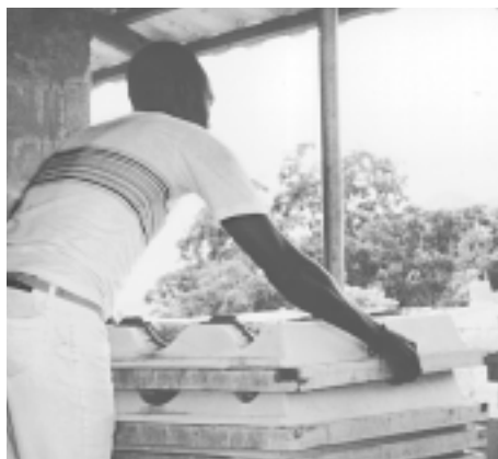
As telhas novas são deixadas nos moldes para endurecer.
