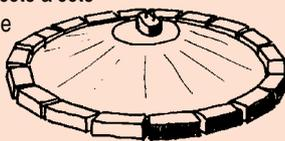
**2** Tassez (en marchant dessus) un tas de sable humide à l'intérieur du cercle, de façon à ce que l'on ne voit que 4cm des briques et que le centre du tas soit 10cm plus haut que le niveau du sable au ras des briques. Vous pouvez lisser le sable avec un morceau de bois pour obtenir une forme régulière. Couvrez le sable de papier humide. Ajoutez un moule en bois huilé pour l'ouverture.
