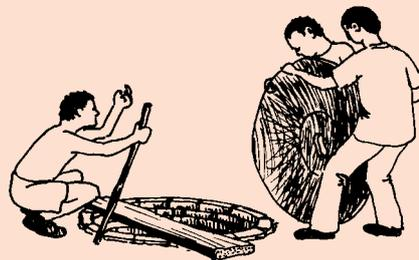
**5** Vous pouvez utiliser la dalle au-dessus d'une fosse non-renforcée de 1,1m de diamètre, mais il y a toujours un risque d'effondrement des parois. Il vaut donc mieux prévoir une fosse avec un rebord renforcé de la même taille que la dalle.
