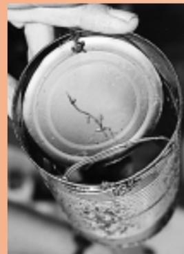
Charlie prende uma lata velha a uma vara e utiliza-a para retirar, misturar e derramar a pasta líquida. Para misturar a pasta líquida no digestor de maneira eficiente, ele adapta este instrumento e acrescenta uma válvula simples. Ele remove o fundo da lata e faz uma dobradiça para ela com arame num lado da lata, usando um laço de arame maior como trava (travão) no lado oposto. Isto permite que ele 'puxe' a pasta líquida do fundo do tambor, misturando-a bem.
