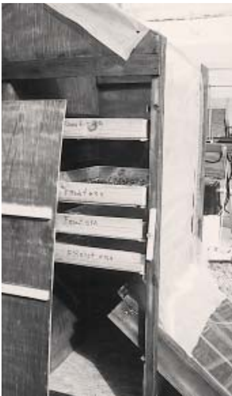
Une vue du séchoir avec son côté amovible retiré, montrant l'arrivée d'air et les plateaux de séchage.
