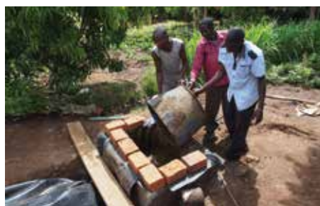
Cómo llenar de estiércol un digestor de biogás.
