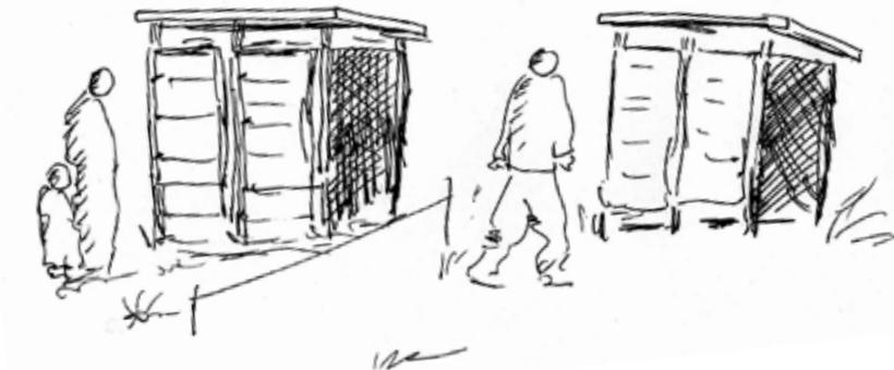
As latrinas têm de ficar a pelo menos 30 m da fonte de abastecimento de água mais próxima e ser suficientemente fundas para durarem no mínimo duas semanas. Se, no entanto, o lençol de água subterrânea estiver alto, as valas deverão ser menos fundas e deverão ser mudadas com mais frequência. As paredes e divisórias podem ser feitas de esteira ou material plástico para permitir privacidade.
