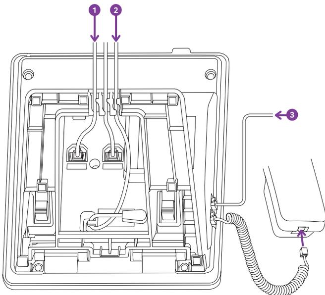
Подключите к устройству сетевой кабель, шнур телефонной трубки и адаптер переменного тока (опционально).
