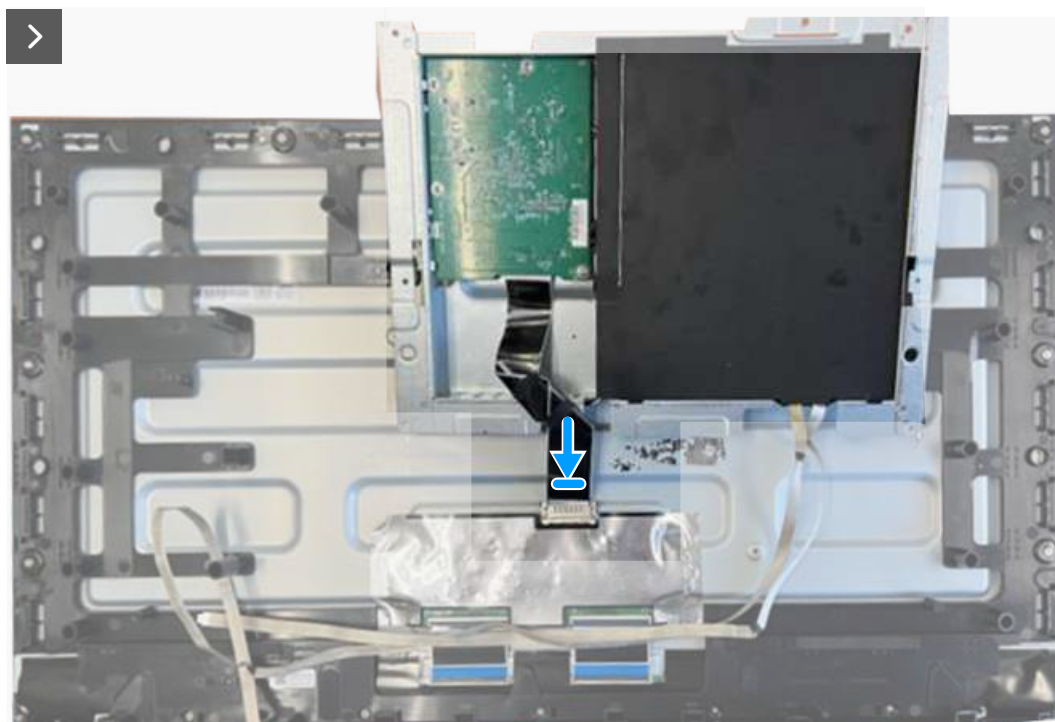
Joonis 14. Paneelikaabli ühendamine
