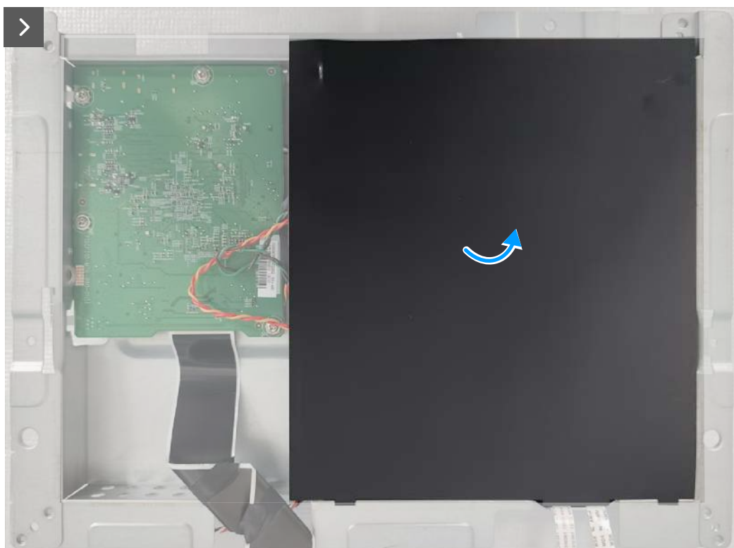
Joonis 17. Mylar-lehe eemaldamine
