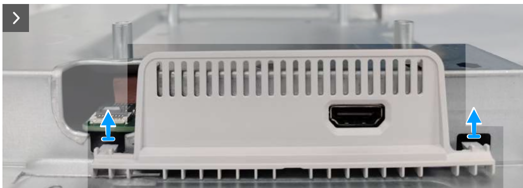
Joonis 18. I/O-katte metallvarje eemaldamine
