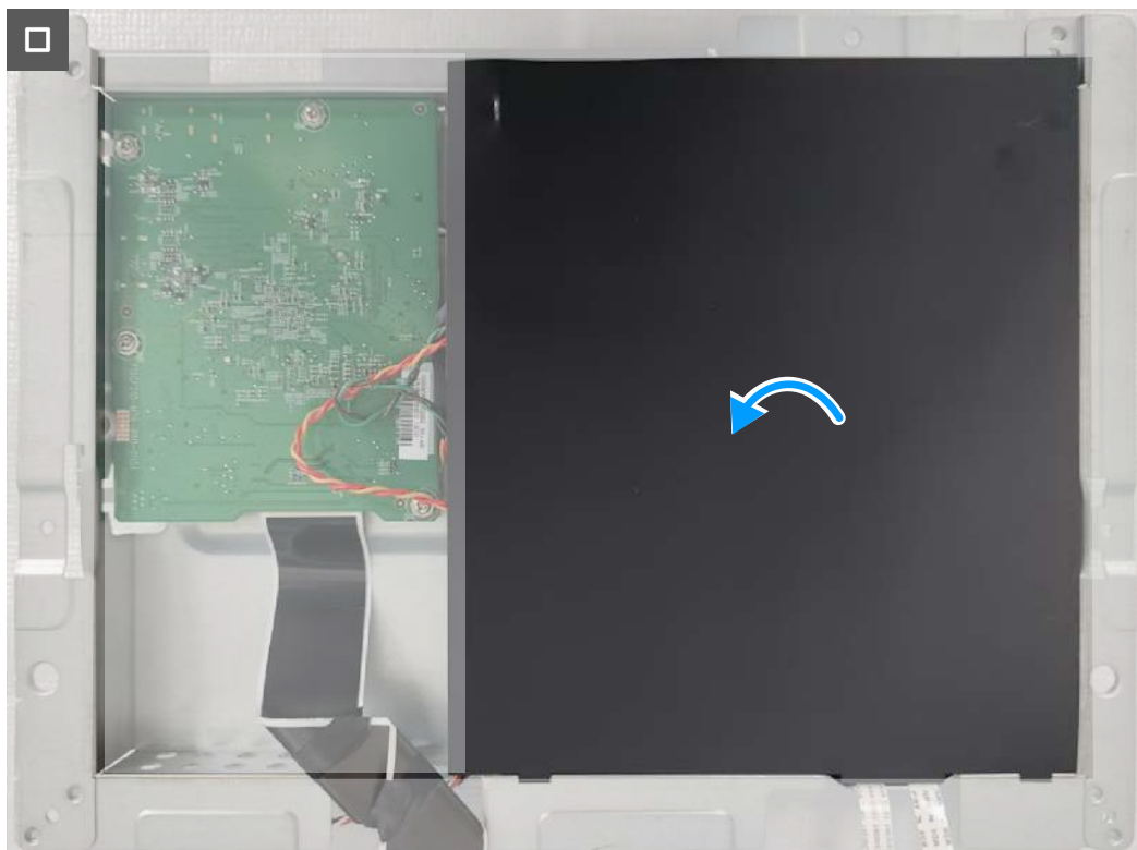
Joonis 24. Mylar-lehe paigaldamine
