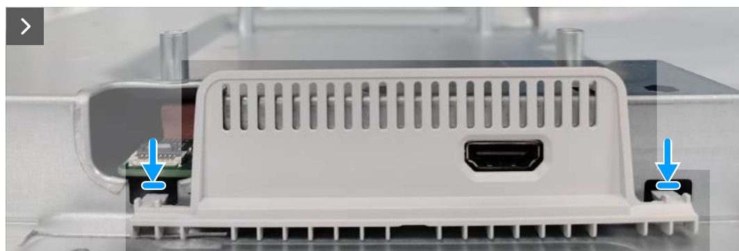
Joonis 23. I/O-katte metallvarje asendamine
