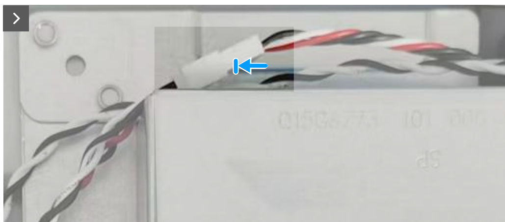
Joonis 9. Kõlari kaabli ühendamine
