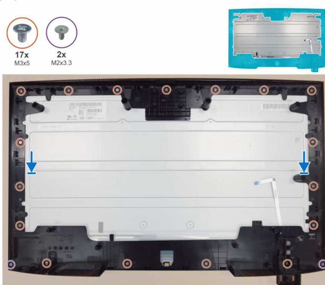
Joonis 33. Keskraami paigaldamine
