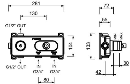
3/4"寸管径预埋式恒温开关
