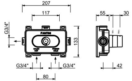
**3/4" 寸管径止水阀**
