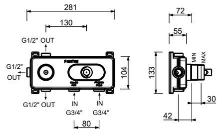
**3/4"寸管径预埋式恒温开关**
