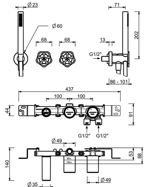
3/4"寸管径预埋式恒温开关
