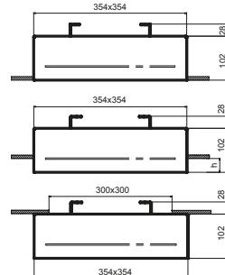
**W098****Cupolino per installazione del soffione nel soffitto di un Hammam**
