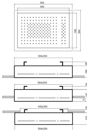
**W098****Cupolino per installazione del soffione nel soffitto di un Hammam**
