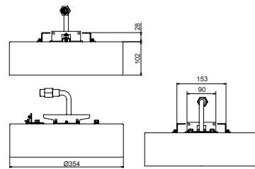
**W098****Cupolino per installazione del soffione nel soffitto di un Hammam**
