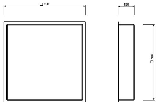
**ART. W098****Kuppel zum Einbau der Kopfbrause in der Decke eines Dampfbads**
