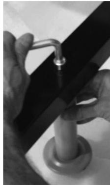
4. Montare le ruote, sulla traversa lato testata, agendo con la chiave esagonale in dotazione; serrare a fondo.
