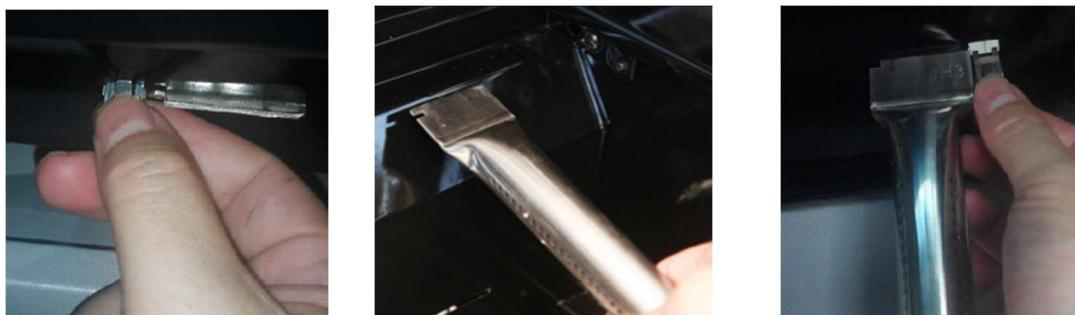
Upprepa steg 1 från höger till vänster för att ta bort huvudbrännaren och överföringsramen tills den defekta brännaren tagits bort.
