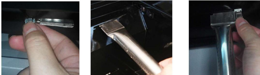
Toista vaihe 1 oikealta vasemmalle pääpolttimen ja siirtorungon irrottamiseksi, kunnes viallinen on poistettu.
