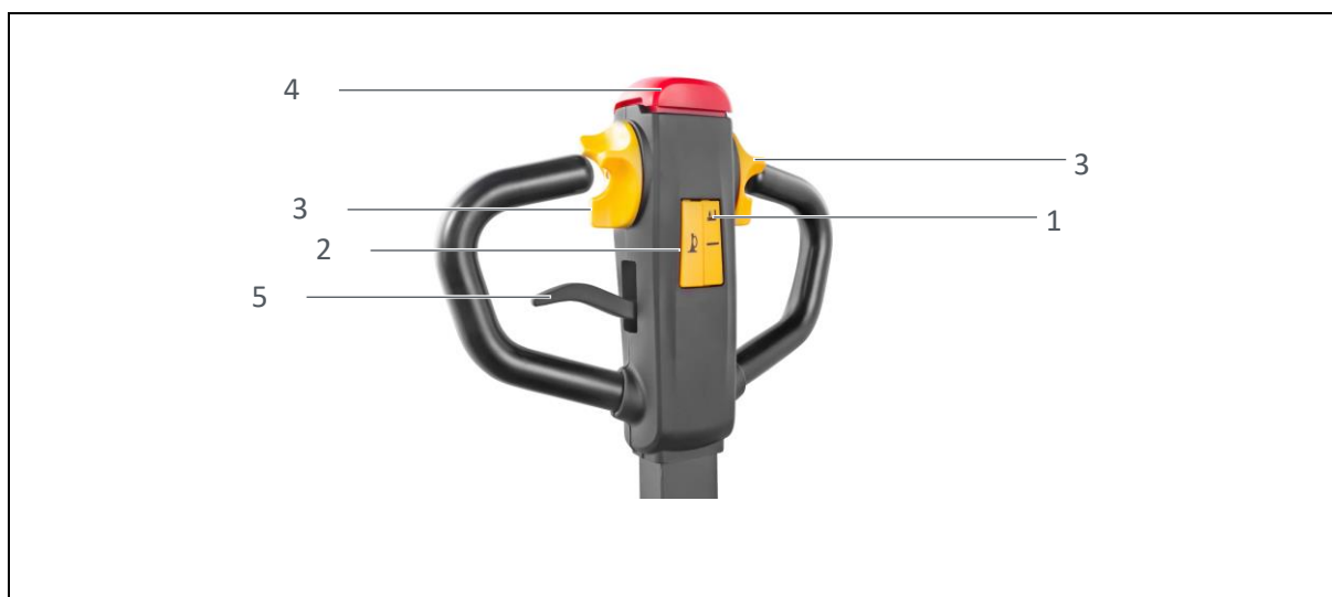
Abb. 3: Hauptkomponenten der Deichsel
