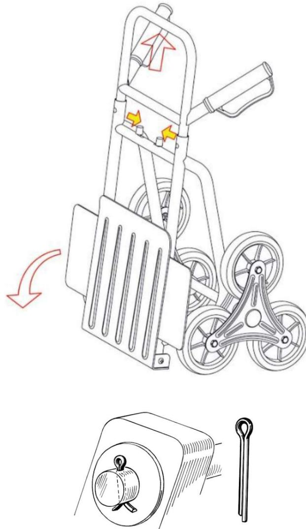
Per utilizzare il carrello a mano, inclinarlo leggermente in avanti e spingere la benna sotto il carico. Assicuratevi di portare la benna sotto il carico fino al limite massimo. Quindi inclinare con cautela il carrello manuale verso di sé per poter sollevare e spostare il carico.
