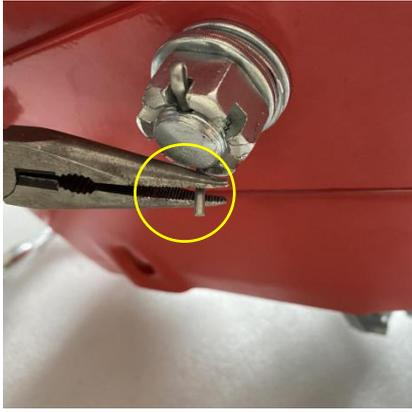
Inserire il perno nel foro dell'asta (9) e piegarlo.
