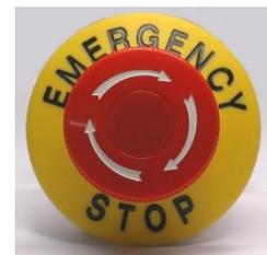
bouton d'arrêt d'urgence dans le sens des aiguilles d'une montre, ce qui déverrouille la clé rouge. Le treuil à câble est maintenant prêt à fonctionner.
