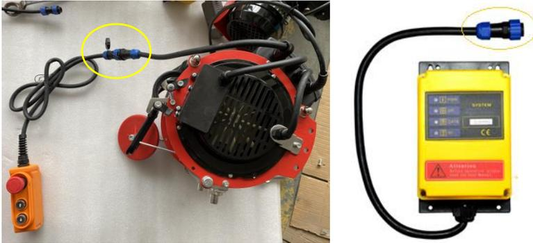
2. Avvitare gli elementi a innesto dell'argano a fune e della centralina di comando. Prestare attenzione ai punti di connessione.
