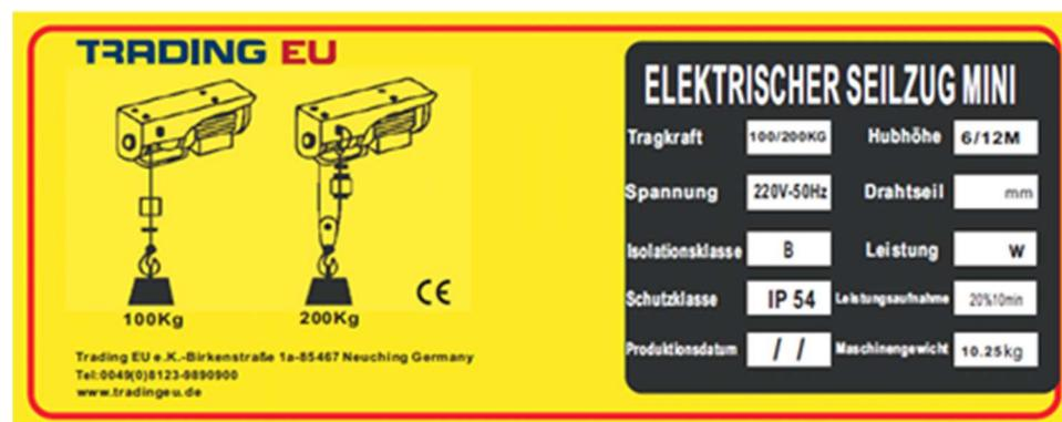
Abbildung 2-1: Typenschild des Seilzuges (beispielhafte Darstellung)
