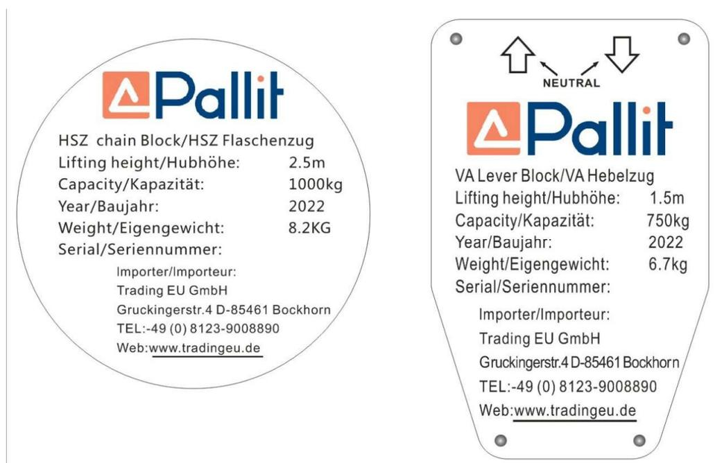
Abbildung 2-1: Typenschild des Kettenzuges (beispielhafte Darstellung)
