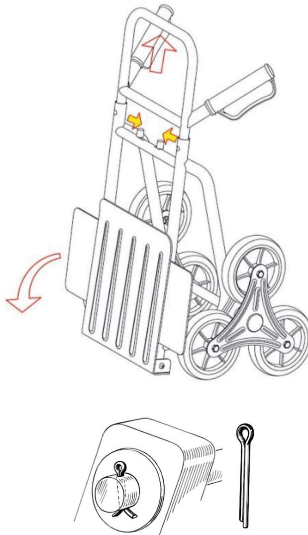
Um die Sackkarre zu verwenden, kippen Sie sie leicht nach vorne und schieben Sie die Schaufel unter die Last. Stellen Sie sicher, die Schaufel bis zum Anschlag unter die Last zu bringen. Danach kippen Sie die Sackkarre vorsichtig zu sich, um die Last anzuheben und verfahren zu können.
