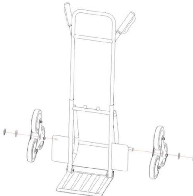
1. Stecken Sie die Stahlrohrkonstruktion zusammen. Achten Sie darauf, dass die Sicherung fest einrastet.
