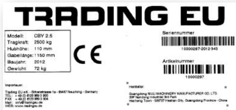
Abbildung 2-1 Gabelstapler-Kennzeichen (beispielhafte Darstellung)
