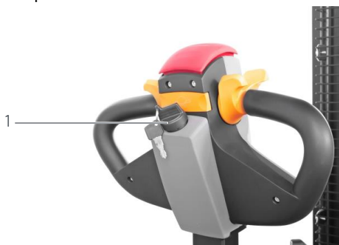
Fig. 11: serrure de contact à l'arrière de la barre d'attelage
