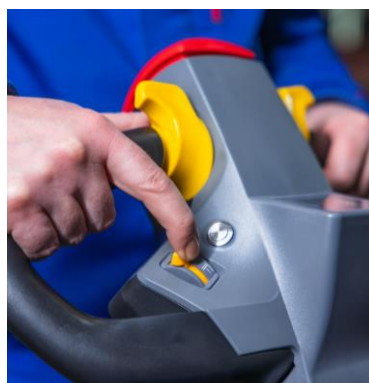
Abb. 20: Handposition beim Senken des Ladeguts
