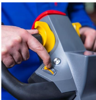
Fig.20: Posizione delle mani durante l'abbassamento del carico
