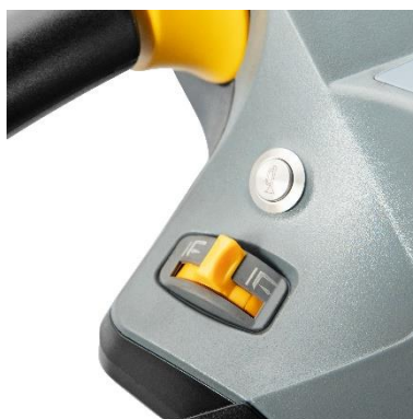
Fig.19: Interruttori per il sollevamento e l'abbassamento sul timone
