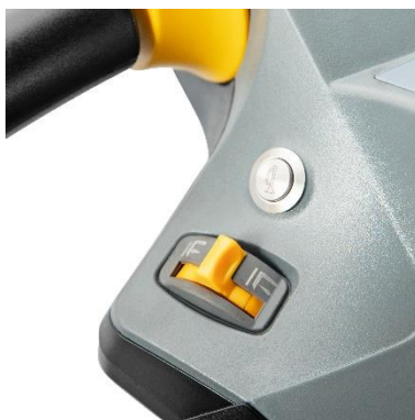
Fig.19: Commutateurs de levage et d'abaissement sur le timon
