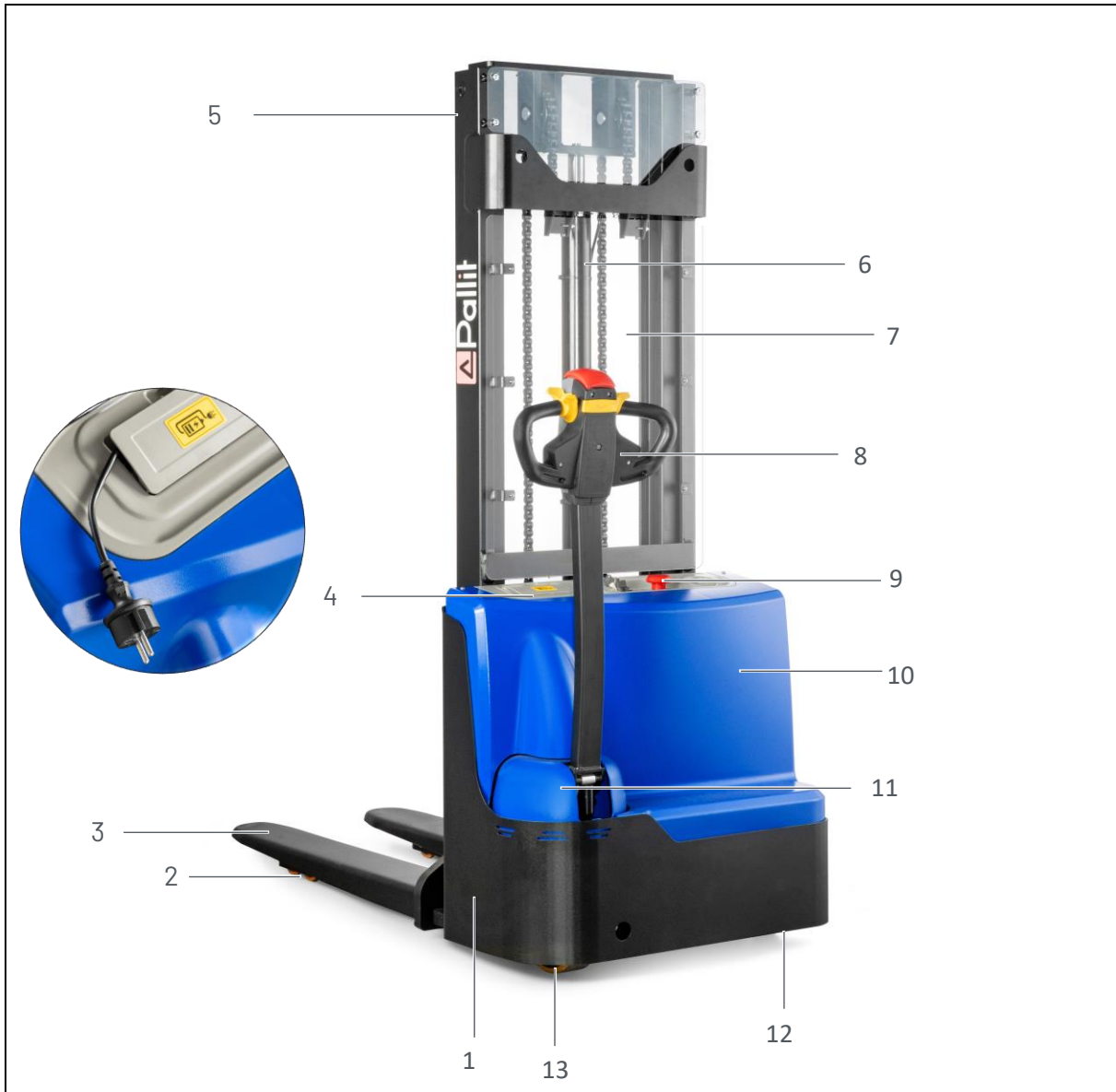
Abb. 6: Maschinenansicht mit Detailansicht Ladeschnittstelle
