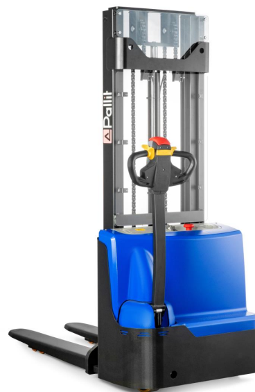
Abb. 11: Gabel in unterster Position
