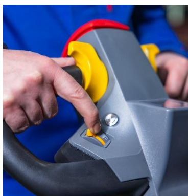
Fig.20: Position des mains lors de l'abaissement de la charge
