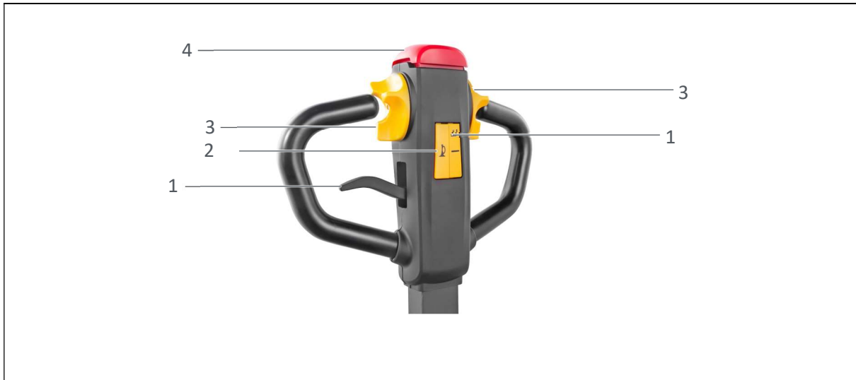
Fig. 5: Componenti principali del timone (anteriore e posteriore)
