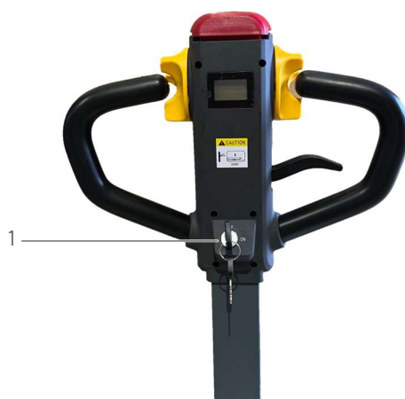
Fig. 11: Blocco dell'accensione sul retro della barra di traino
