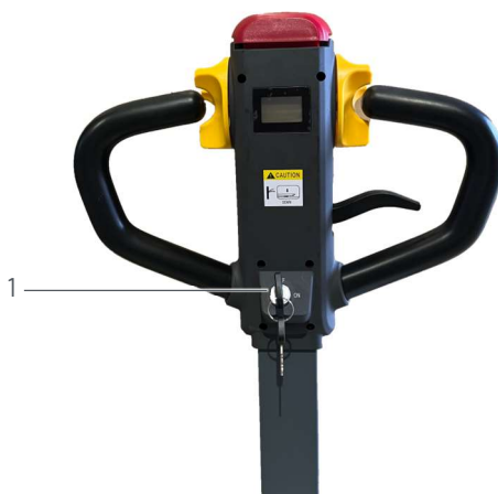
Abb. 9: Zündschloss an der Rückseite der Deichsel
