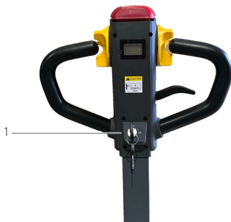
Fig. 9: serrure de contact à l'arrière de la barre d'attelage
