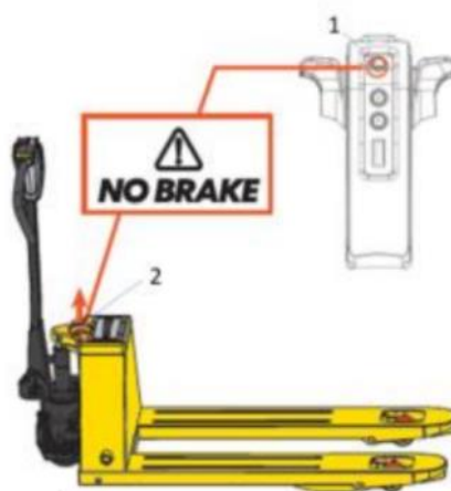
Fig.82 : Disattivazione del freno
