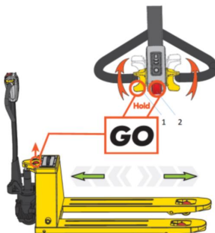
Abb. 16: Aktivieren der Fahrt mit aufrechter Deichsel
