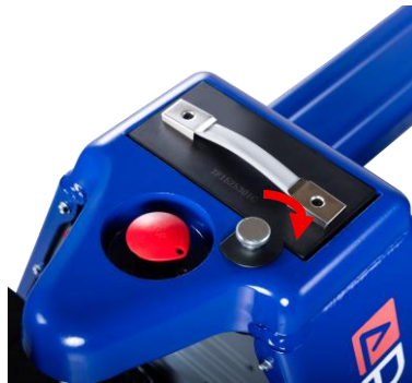
Fig.85 : protezione della batteria
