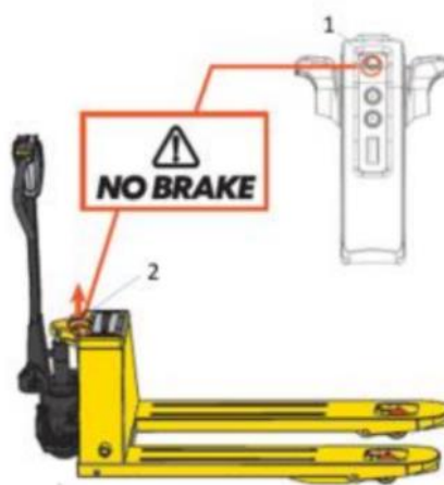
Abb. 17: Deaktivieren der Bremse
