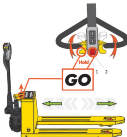
Fig.60 : Activation de la marche avec le timon en position verticale
