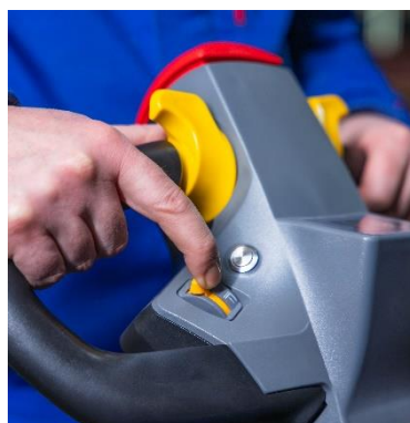
Fig.20: Posizione della mano durante l'abbassamento del carico
