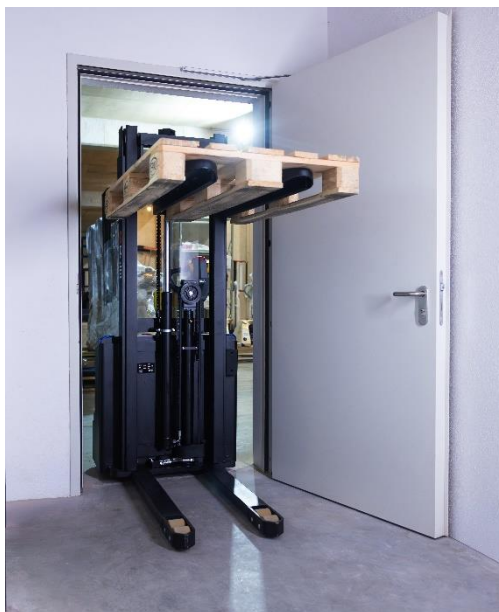
Fig.22 : Esempio di situazione di marcia con corsa libera
