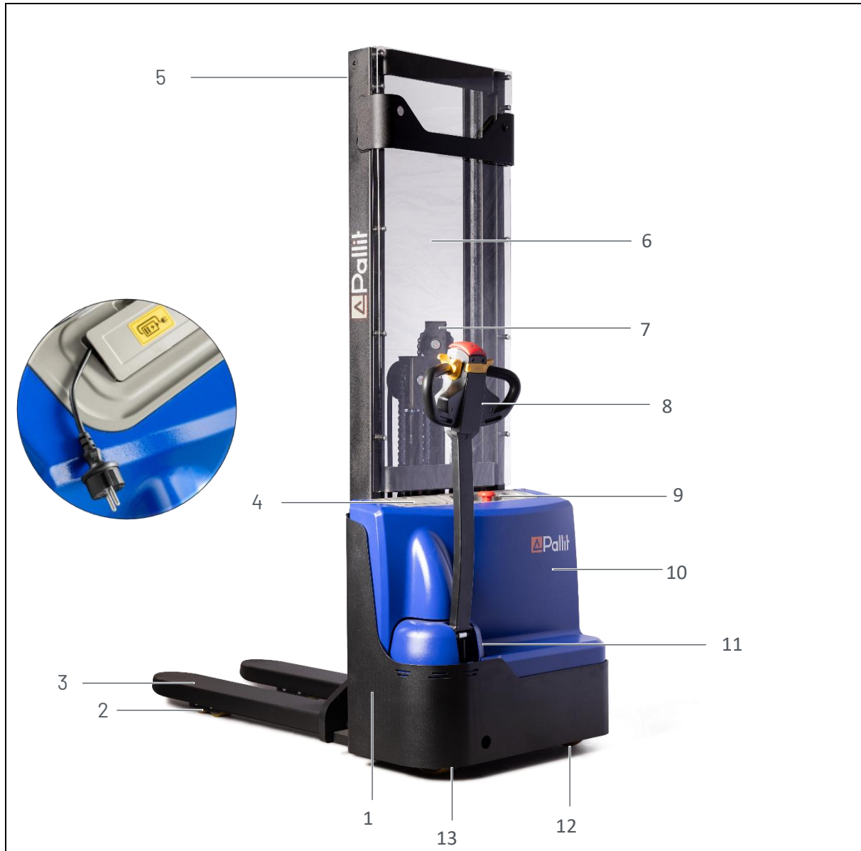
Abb. 6: Maschinenansicht mit Detailansicht Ladeschnittstelle
