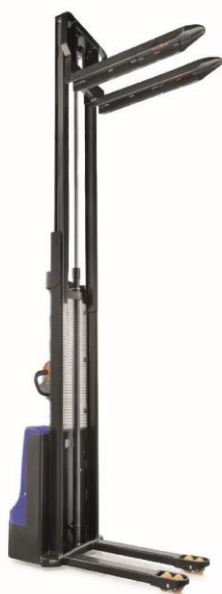
Fig. 15: Forca in posizione superiore
