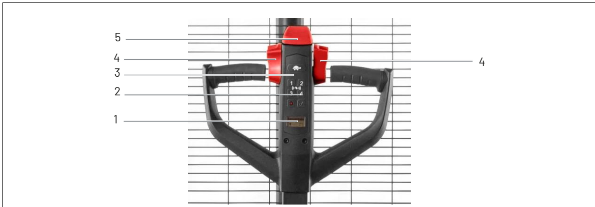
Fig. 11: Componenti principali del timone SMART-XL
