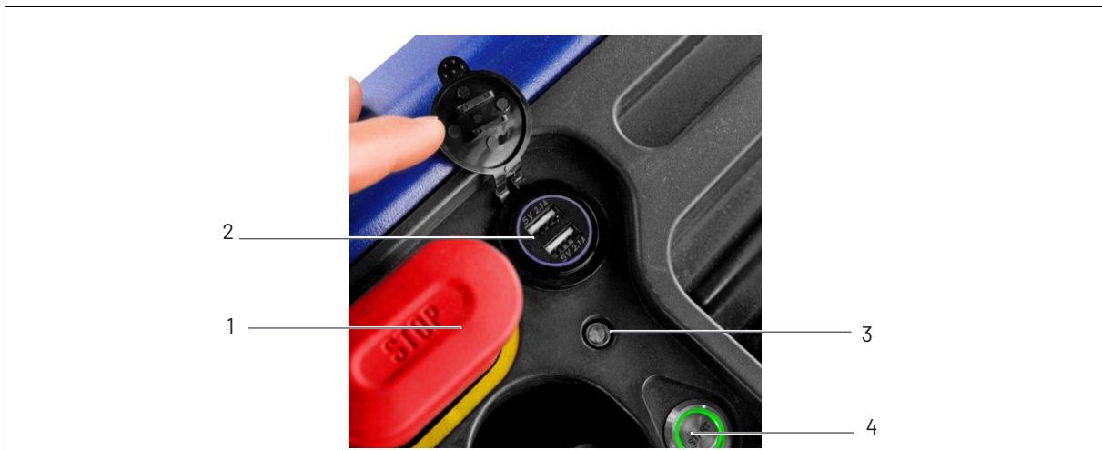
Fig. 12: Dettaglio dell'interfaccia di ricarica SMART-XL
