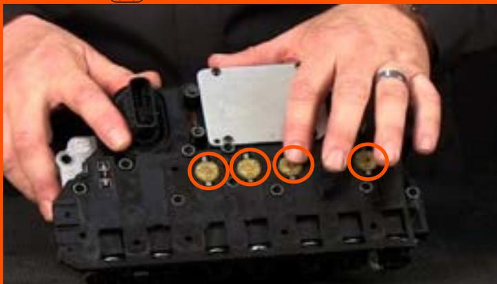
Модели GEN1 отличаются наличием 4 реле давления в электрогидравлическом блоке управления (TENCM).
