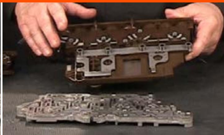
Модели GEN1 отличаются наличием 4 реле давления в электрогидравлическом блоке управления (ТЕНСМ).
