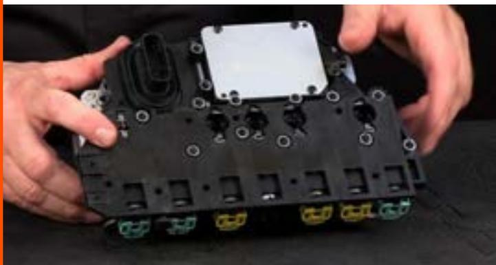
Модели GEN2 не имеют реле давления в электрогидравлическом блоке управления (TENCM).
