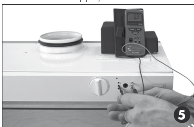
Mittaa jännite navoista – ja S, säädä nopeus 2 potentiometrillä 2, jne.
