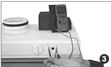
Mittaa jännite navoista – ja S, säädä esim. nopeus 1 potentiometrillä 1
