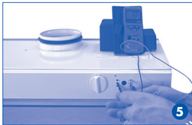
Mittaa jännite navoista – ja S, säädä nopeus 2 potentiometrillä 2, jne.
