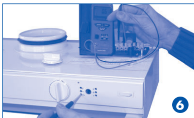
Voit tehdä mittauksen myös liitinrimalta, sähkökaavion osoittamista paikoista.
