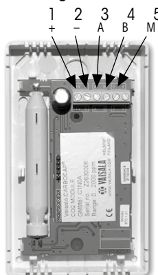
CO 2 -givarens elektronikkort (modellen kan variera)
