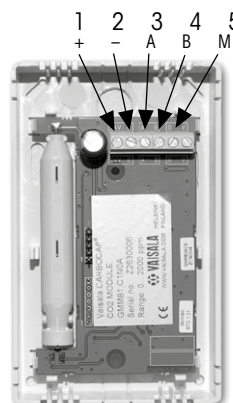
CO 2 -anturin elektroniikkakortti (malli saattaa vaihdella)
