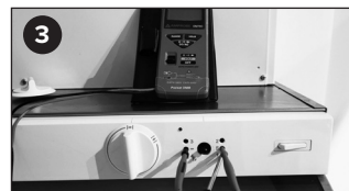
3 Mittaa jännite navoista – ja S, säädä esim. nopeus 1 potentiometriltä 1
