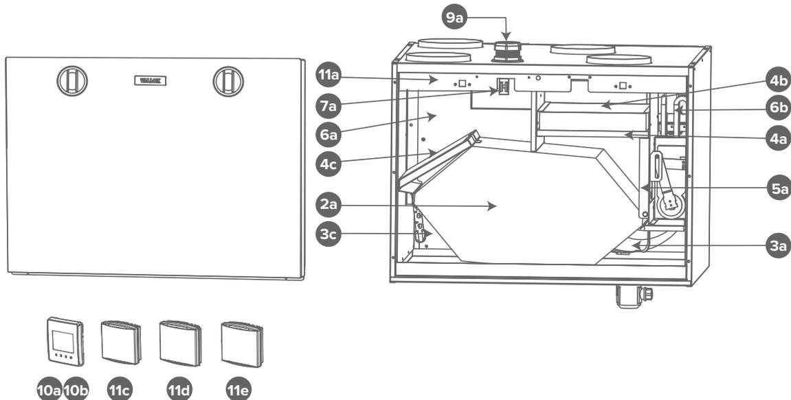
**2a** **ENG** Heat recovery cell **FIN** Lämmöntalteenotokkeno **SWE** Värmeväxlare **DAN** Varmevexsler **EST** Soojusvaheti **LIT** Rekuperacinis šilumokaitis **LAV** Siltuma atguves elements **RUS** Рекуператор тепла **POL** Zespół wymiennika ciepła **CZE** Tepelná rekuperační komora **SLO** Rekuperátor **DUT** Warmtewisselaar **FRA** Échangeur de chaleur **GER** Wärmetauscher.
