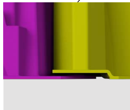
Overlap i bunden imellem den lille ribbe og Endemodulet.
