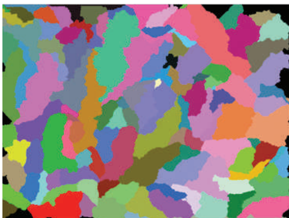
Ilustración 1. Ejemplo de mapa de salida plugin r.watershed que representa la delimitación sugerida de subcuencas dentro del MDE utilizado.
