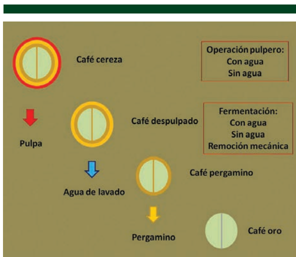
Gráfica 2. Esquema del beneficio empleado en Guatemala. La pulpa se elimina en el pulpero, el cual puede operar con o sin la adición de agua. El mucilago se elimina por fermentación, la cual se lleva a cabo sin la adición de agua, sin embargo, en otros países ocurre bajo agua. El café fermentado se lava y luego se deshidrata. El café en pergamino se elimina manualmente en instalaciones que en el país se denomina beneficio seco. El café en oro se almacena en sacos para su eventual exportación.
