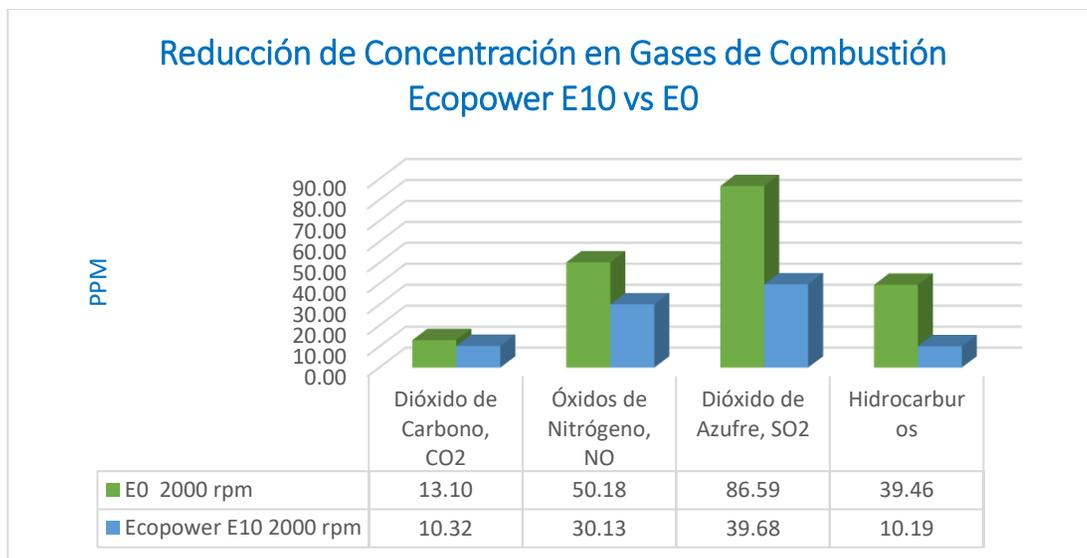
Figura 8. Reducción en la concentración de CO utilizando la mezcla E10 en comparación con la E0.
